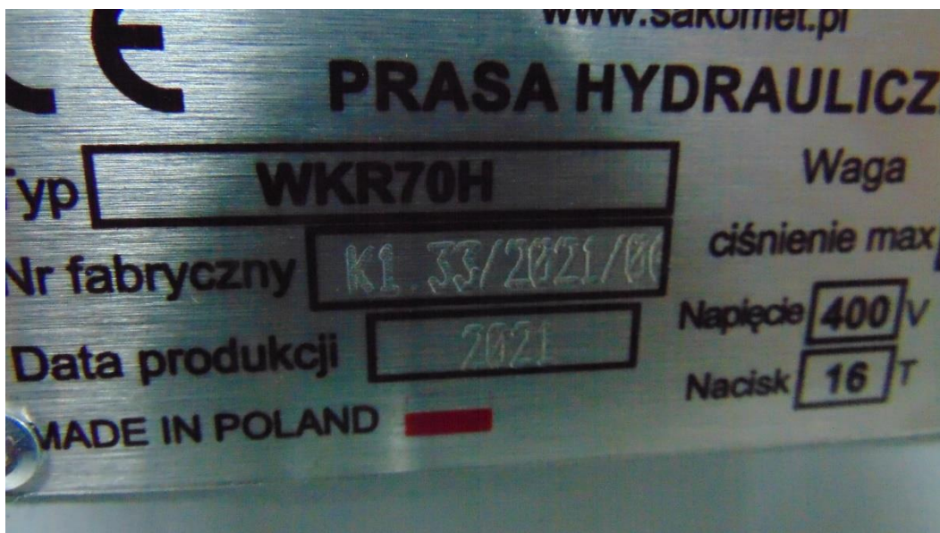
Tabliczka znamionowa prasy hydraulicznej.
