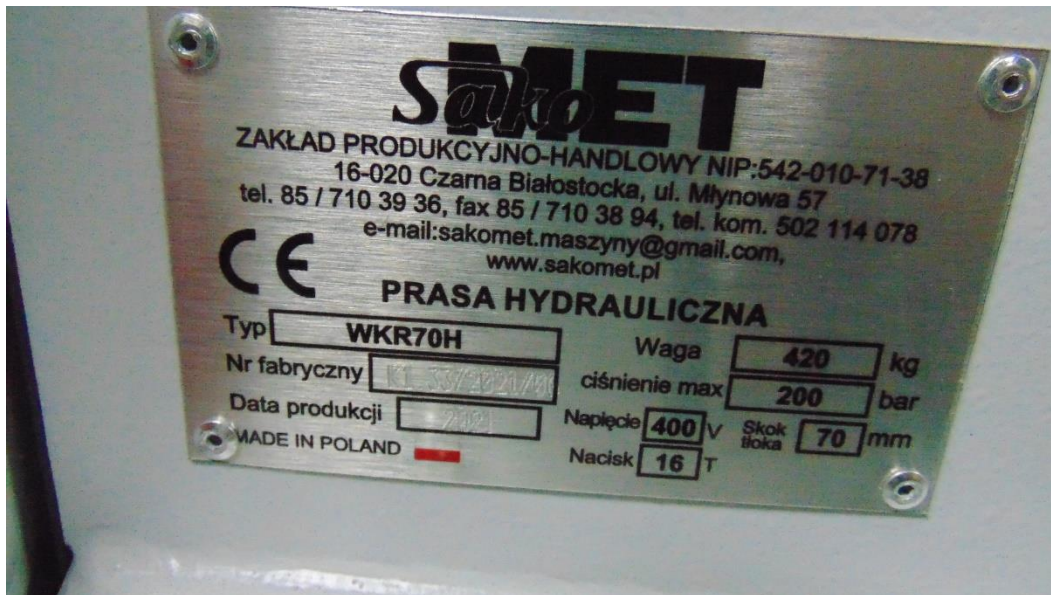
Tabliczka znamionowa prasy hydraulicznej.
