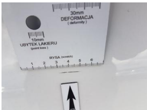
Fot. 37 Błotnik tylny lewy/ściana boczna lewa (Rysa/Odprysk)
