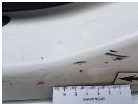
Fot. 38 Próg lewy (Rysa/Odprysk)
