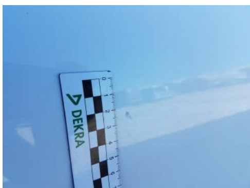
Fot. 29 Drzwi tylne prawe (Rysa/Odprysk)
