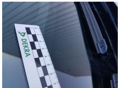
Fot. 24 Szyba czołowa (Rysa/Odprysk)
