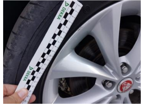
Fot. 34 Felga przednia lewa (Rysa/Odprysk)
