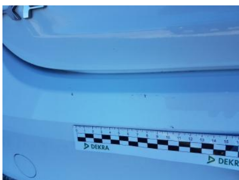
Fot. 31 Zderzak tylny (Rysa/Odprysk)
